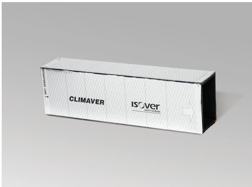
Panel rígido de Lana de Vidrio ISOVER con excelente reacción al fuego, ya que no contribuye al incendio en ninguna fase del mismo. Es un panel de alta densidad, revestido por la cara exterior con una lámina de aluminio reforzada con malla de vidrio, que actúa como barrera de vapor, y por su cara interior, con un tejido neto de vidrio reforzado de color negro de gran resistencia mecánica.
