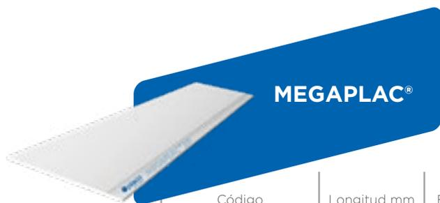
Placa de Yeso Laminado con los bordes longitudinales afinados, de 900 mm de anchura, que proporciona una gran robustez, rápida instalación y ahorro de material gracias a su espesor de 25 mm.
