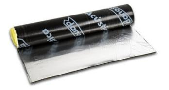
MAD PRO es una lámina acústica bituminosa armada con cargas minerales con cobertura aluminizada. Su masa aporta una gran aislamiento acústico actuando como elemento antiresonante a una cara, como elemento plástico entre elementos rígidos o como resonador membrana entre elementos resorte. Además, se caracteriza por poseer un excelente comportamiento ante el fuego (bs1d0), actuar como barrera de vapor y como termo-reflexivo en cámara.
