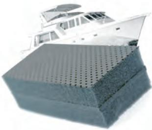
**Composición:** Revestimiento de PVC beige perforado, espuma de poliuretano absorbente y una masa pesada visco elástica de 5 kg/m<sup>2</sup> intercalada.
