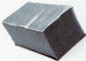
**Composición:** Revestimiento de aluminio con soporte de fibra de vidrio, espuma de poliuretano absorbente y masa pesada visco elástica de 5 kg/m<sup>2</sup>.
