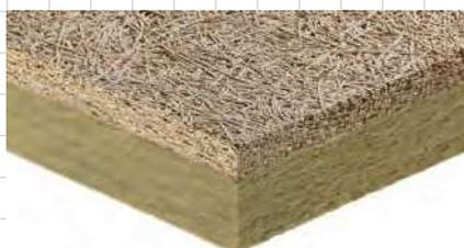
Panel térmico y acústico mineral compuesto por una capa de Celenit AB micro de 25 mm, adherida a una capa de lana de roca, de 25 o 50 mm. Usos: Falsos techos, revestimientos de paredes. Elaboración de cantos: Recto o biselado. Medida de placa exacta 120x60 cm. No permite su instalación con guía T. Los paneles se pueden atornillar directamente en el techo o la pared, o en una estructura oculta.
