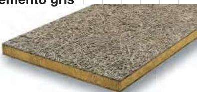
Panel sándwich compuesto de dos estratos, de 5 mm de espesor cada uno, de viruta gruesa de madera (abeto), aglomerado con cemento Portland gris, firmemente adheridos a un estrato interno de lana de roca de alta densidad, orientada e incombustible. USOS: Revestimientos de gran absorción acústica. Aislamiento acústico. Resistencia al fuego. Aislamiento de tejados planos e inclinados.
