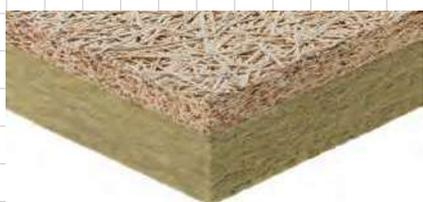
Panel térmico y acústico mineral compuesto por una capa de Celenit AB de 25 mm, adherida a una capa de lana de roca, de 25 o 40 mm, recubierta por un lado con velo de vidrio. Usos: Falsos techos, revestimientos de paredes. Elaboración de cantos: Recto, biselado, P10 o P11. Dos Medidas de placa: Placa Celenit 120x60 cm exacta + lana de roca de 120x50 cm (para aplicación directa sobre estructura), Placa Celenit + lana de roca de 119,3x59 cm (para colocación sobre perfil T/35).
