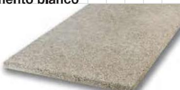
Panel acústico de viruta ultrafina de madera (abeto), aglomerado con cemento Portland blanco. USOS: Falsos techos y revestimientos naturales, fonoabsorbentes, transpirables y resistentes al fuego. Panel calibrado.
